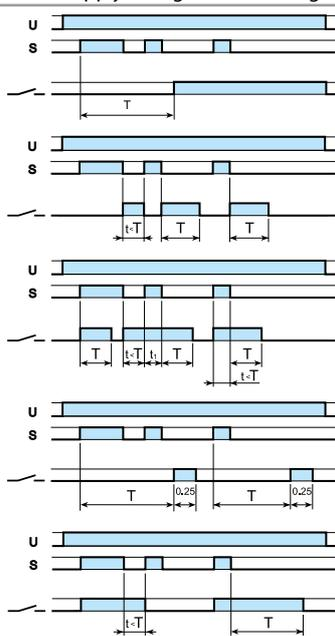
**(AE) On-delay with control signal.**
